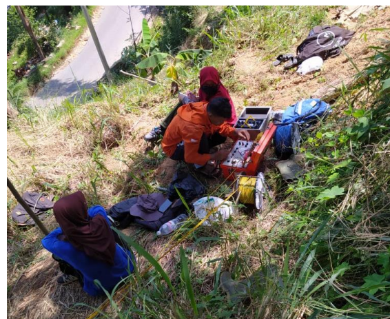
Gambar 4. Pengukuran geolistrik resistivitas 2D menggunakan alat GF Instrument ARES 3000 .
