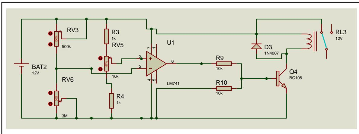
Gambar 2. Skematik rangkaian sistem kontrol irigasi
