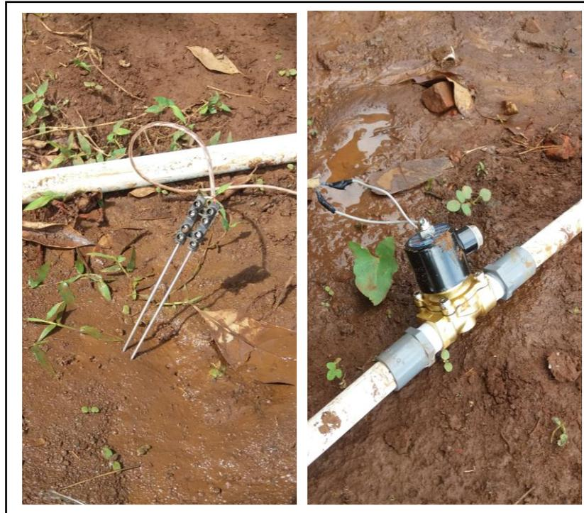
Gambar 3. Elektroda (kiri) dan katup solenoid (kanan)
