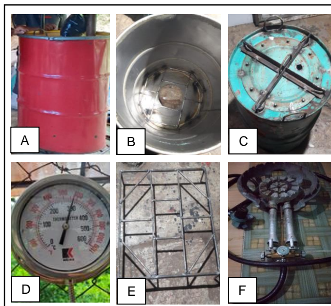
Gambar 2. Tungku Pengarangan (A), bagian dalam drum besar (B), drum kecil (C), Termometer (D), Penyanggah kompor (E), dan Kompor (F).
