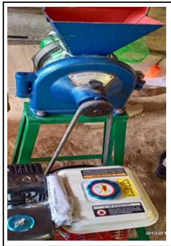
Gambar 4. Mesin Penggiling arang.
