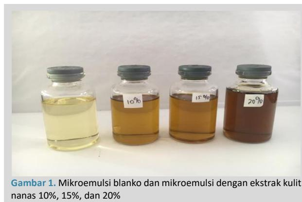
Gambar 1. Mikroemulsi blanko dan mikroemulsi dengan ekstrak kulit nanas 10%, 15%, dan 20%
