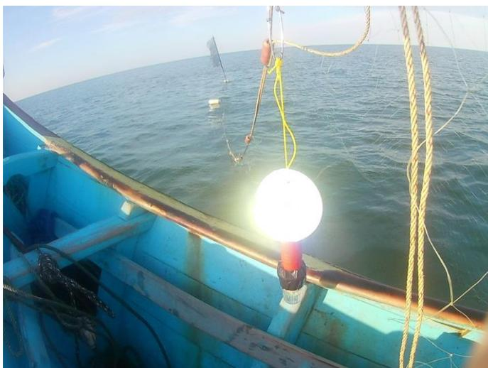
Gambar 4. Pemasangan lampu hijau dan disk komputer pada tali ris atas pukat bawal yang diuji.
