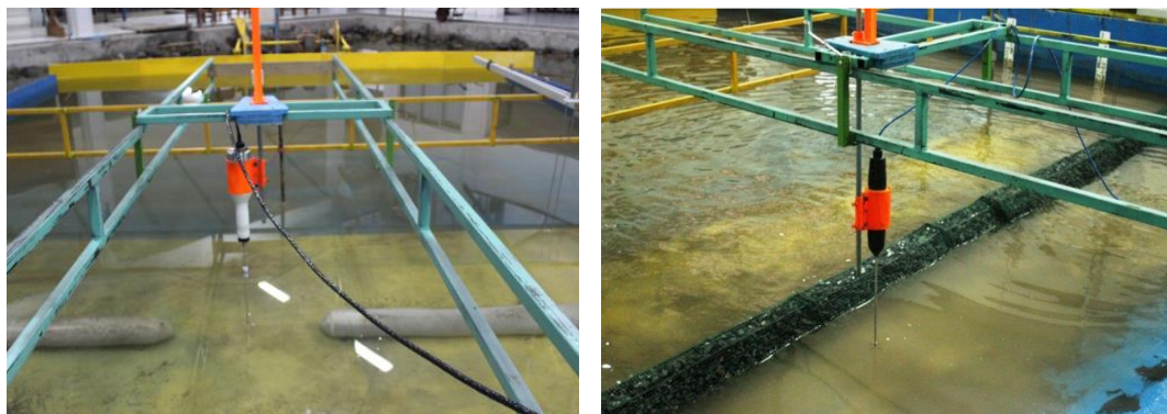
Gambar 1. Uji Model dinamika arus sekitar PEGAR di Lab Hidraulika TSL-UGM (Sulaiman, 2014)
