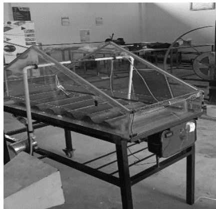
Gambar 3. Alat destilasi air laut menggunakan energi surya dan elektrik (Penelitian, 2019)
