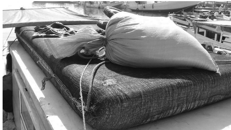
Gambar 4. Penyimpanan alat keselamatan yang tidak sesuai, terbungkus karung
