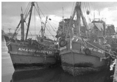
Gambar 1. Lambung kapal ikan dipenuhi biofouling
