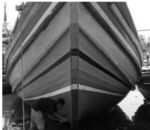
Gambar 3. Pengambilan data ketebalan biofouling pada lambung kapal ikan
