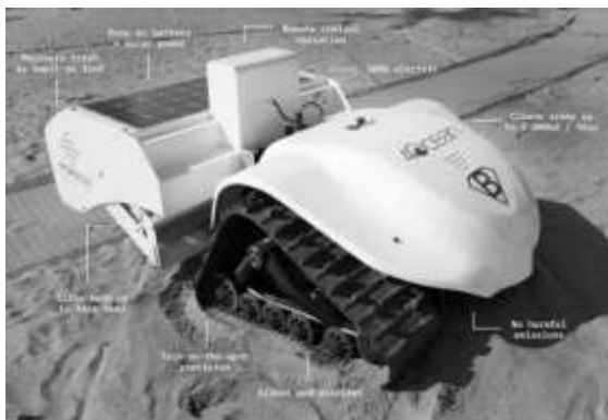
Gambar 2. Gambar dan struktur BeBot
