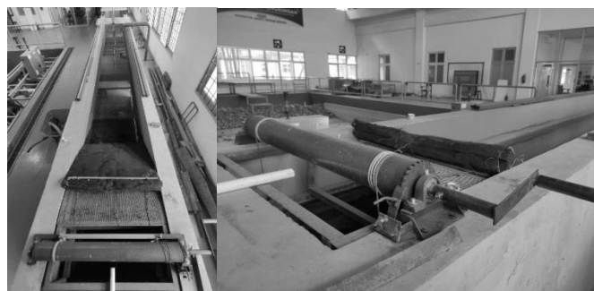
Gambar 2. Model peredam gelombang yang pasangkan pada wave flume
