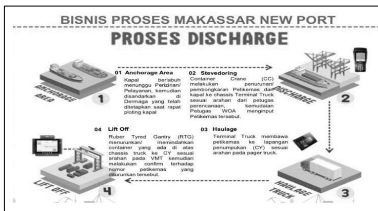
Gambar 3. Proses Bongkar Petikemas dari Kapal ke Container Yard (Bisnis Proses MNP, 2021)
