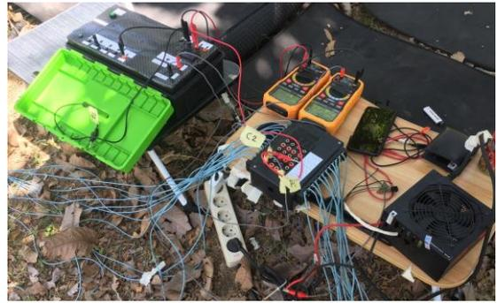
Gambar 8 Pengujian lapangan setelah semua komponen data logger resistivity meter dirakit
