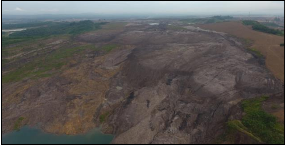
Gambar 1. Kondisi aktual Tiung-AB Dump dengan pembentukan erosi.
