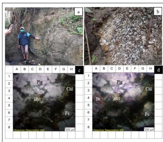
Gambar 4. a). Singkapan Granit, b). Sampel Granit, c). Sayatan Petrografi Granit PPL, d). Sayatan Petrografi Granit XPL
