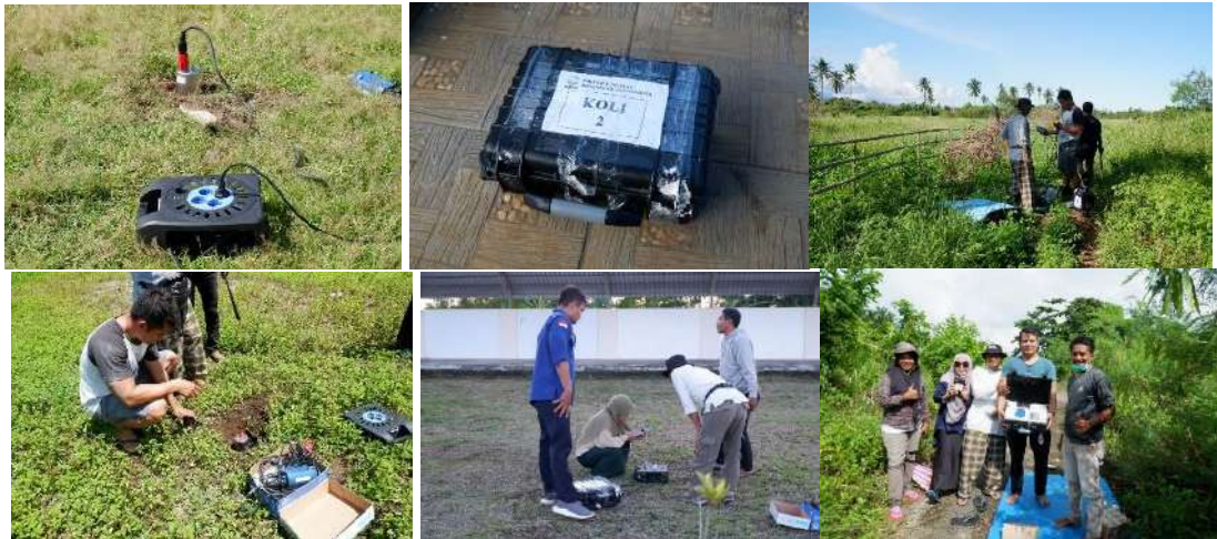
Gambar 3. Dokumentasi pengukuran mikrotremor di lokasi penelitian.
