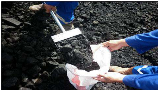
Gambar 4. Pengambilan sampel batubara pada ship loading .
