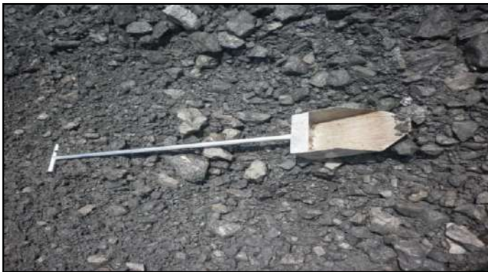
Gambar 3. Pengambilan sampel batubara pada front penambangan.
