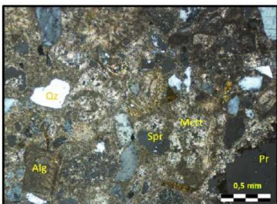
Gambar 2. Kenampakan petrografi wackestone pada stasiun 1 yang tersusun oleh skeletal grain , berupa fosil foraminifera (Fr), koral (Cr) dan alga (Alg). Non-skeletal grain berupa mineral kalsit (Cal) serta matriks berupa mikrit (Mcrt) dan semen berupa sparit (Spr), serta pori (Pr). Skala foto 0,5 mm (terdapat di kanan bawah gambar).
