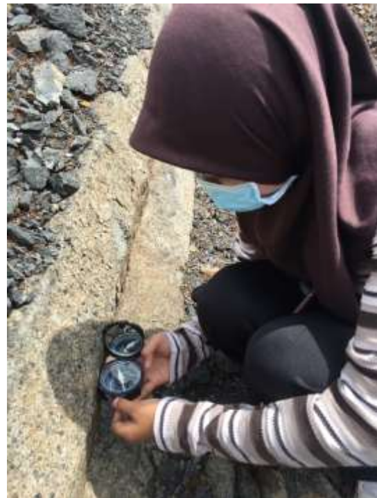
Gambar 1. Pengukuran strike-dip menggunakan kompas geologi di daerah penelitian.
