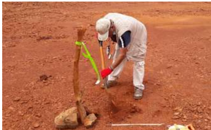
Gambar 1. Pengambilan Sampel Menggunakan Bor Tangan
