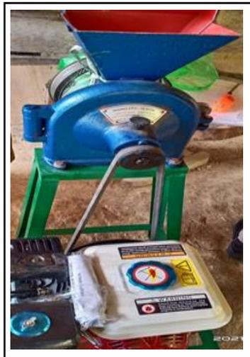
Gambar 4. Mesin Penggiling arang.
