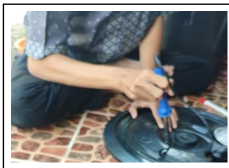
Gambar 4. Proses Melubangi tutup ember menggunakan solder.
