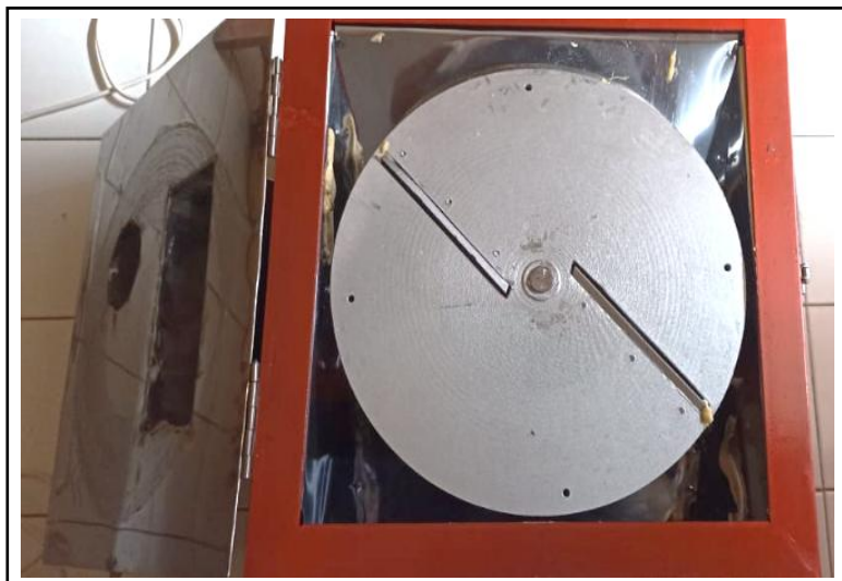
Gambar 2. Bagian Dalam Alat Pemotong Bahan Baku Singkong, Ubi, dan Pisang.
