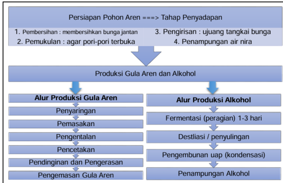
Gambar 2. Alur Produksi Gula Aren dan Alkohol di Desa Manembo
