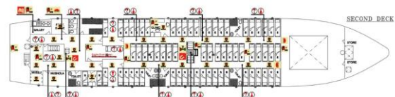
Gambar 15. Desain fire control plan pada second deck Kapal Latih Barombong
