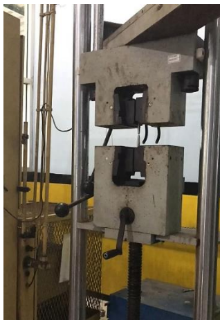
Gambar 2. Spesimen terputus disebabkan oleh beban maksimal
