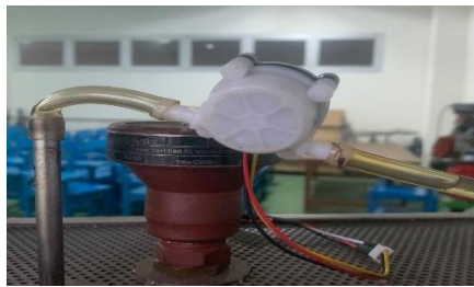
Gambar 7. Peletakan sensor flowmeter
