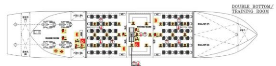
Gambar 14. Desain fire control plan pada double bottom / training room Kapal Latih Barombong
