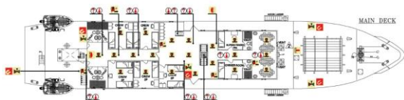
Gambar 16. Desain fire control plan pada main deck Kapal Latih Barombong
