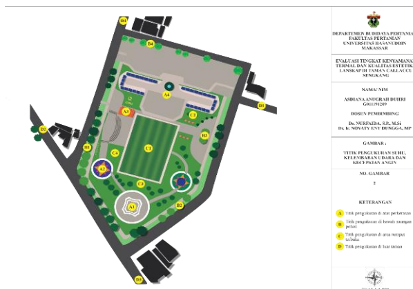
Gambar 1. Titik pengukuran suhu, kelembapan dan kecepatan angin.
