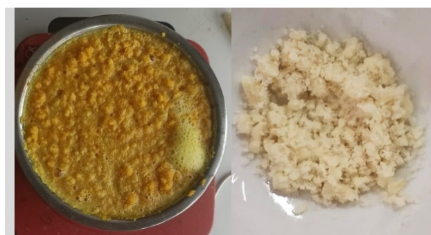
Gambar 2. Proses isolasi \alpha -selulosa KJB (kiri = proses; kanan = hasil)
