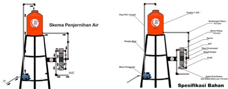
Gambar 2. Skema dan skenario filter di Kampung Birang
