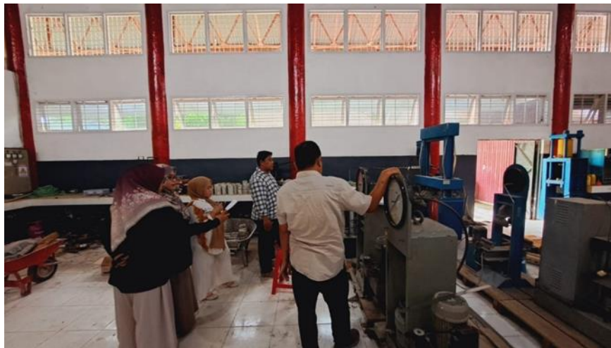
Gambar 4. Kegiatan Pengujian Kuat Tekan Paving
