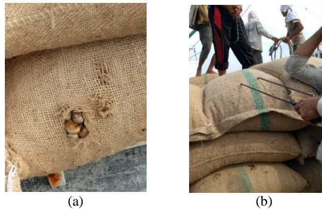
Gambar 3. (a) Cacat produk yang diakibatkan proses bongkar-muat barang dan (b) Alat ganju yang digunakan untuk memindahkan barang
