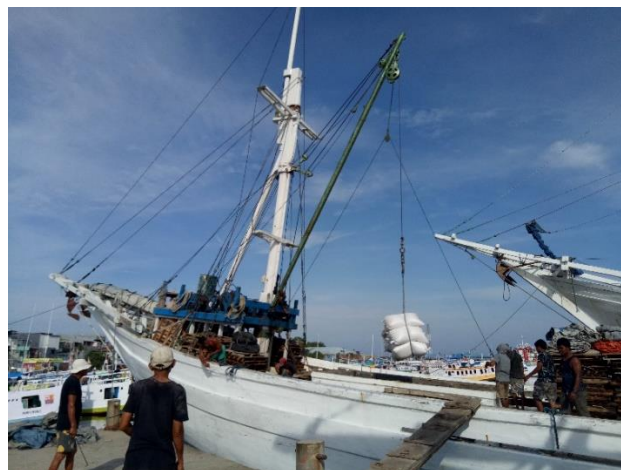
Gambar 2. Modifikasi kapal Phinisi dengan peralatan crane di Pelabuhan Paotere
