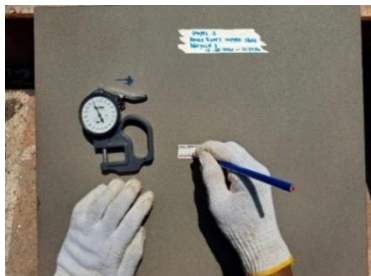
(a) Proses pengukuran tingkat kekasaran permukaan menggunakan alat roughness meter dan replica tape
