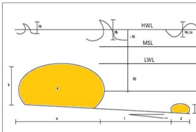
**Gambar 5.** Penempatan karung geotekstil pada posisi muka air rendah (diadaptasi dari Alvarez dkk., 2006)
