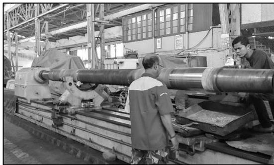
**Gambar 7.** Proses Pembubutan Poros Propeller MV Queen Soya (sumber: dokumentasi pribadi)
