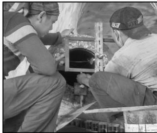
Gambar 6. Proses Pengambilan Titik *Alignment* MV Queen Soya (sumber: dokumentasi pribadi)
